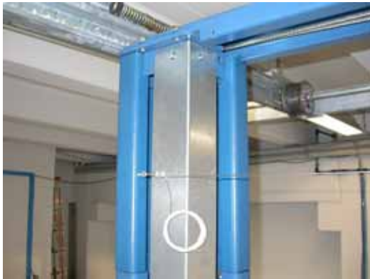
Bild 8: Obere Hubbegrenzung (Seil) nach Montage der Zylinderabdeckung an der Augenschraube anbringen.
